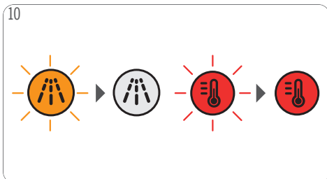
10 Katlakivi eemaldamise näidik lülitub välja, temperatuuri valik vilgub ja põleb ühtlaselt punasena, kui masin on kasutamiseks valmis.
