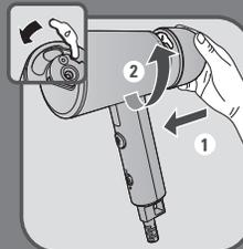
**BS** Zatvorite čep ulaznog otvora za vodu. Vratite spremnik za vodu na njegovo mjesto na aparatu i vodite računa da potpuno nalegne.
