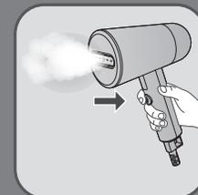
**BS** Pričekaite najmanje 25 sekundi prije pritiska na tipka za paru. Indikator će se isključiti kada je proizvod spreman. Pritisnite tipku za paru. Neka aparat radi dok se spremnik za vodu potpuno ne isprazni.
