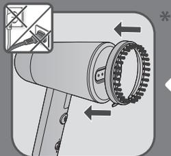
**BS** Četka za tkaninu\* otvara tkanje za bolje prodiranje pare. Prije skidanja ili stavljanja četke parne glave isključite aparat iz strujnog napajanja i pričekajte sat vremena da se aparat ohladi.
