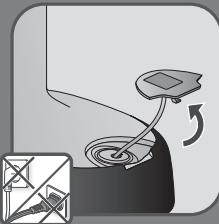
**BS** Otvorite čep ulaznog otvora za vodu i napunite mjeru posudu vodom do oznake za maksimalni nivo.
