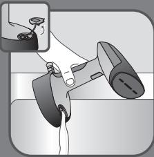
**BS** Potpuno ispraznite spremnik za vodu, a zatim zatvorite čep ulaznog otvora za vodu.
