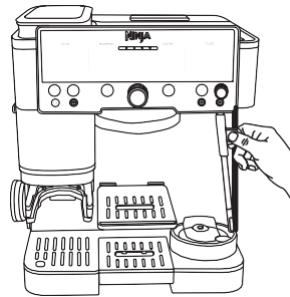
**PIEZĪME:** ierīce neveic tīrišanu, ja tvertnē nav ūdens. Telejiet tvertnē ūdeni un nospiediet pogu TĪRIŠANA, lai izskalotu uzgali.
